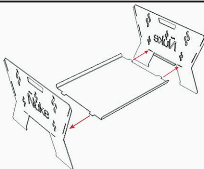
2 - Colocar el lateral encastrando los ganchos y fijarlo desplazándolo hacia abajo
